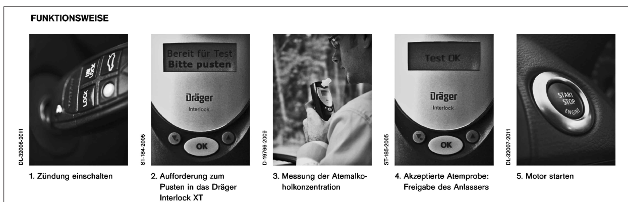
Bild 2: Funktionsweise eines Alkohol-Interlocks (mit freundlicher Genehmigung der Firma Dräger)
